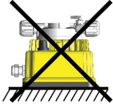
Şekil 11 Pompa Yanlış Montaj Pozisyonu
