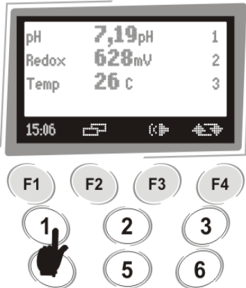
Şekil 27/ Çıkış Modu Kısa Yolu
