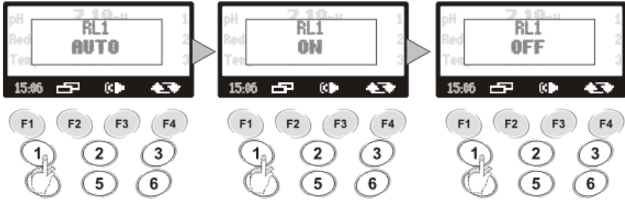
Şekil 29/ Röle Çıkış Modu Değiştirme Örneği
